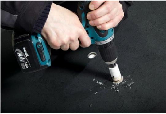
**3.3** Beim Bohren mit der Lochsäge den Bohrvorgang mehrfach unterbrechen, um Späne abzuführen. Es werden niedrige bis mittlere Schnittgeschwindigkeiten empfohlen.
